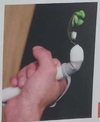
Chiếc thìa có lắp bộ phận luôn giữ cho bộ phận lấy thức ăn ở vị trí không làm đổ thức ăn khi bệnh nhân Parkinson run tay
